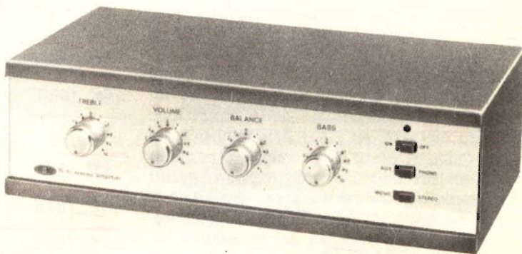
Pannello frontale dell'amplificatore. Da sinistra: regolazione per acuti, volume; bilanciamento, bassi. Sulla destra: interruttore, selettore degli ingressi e commutatore mono/stereo.
